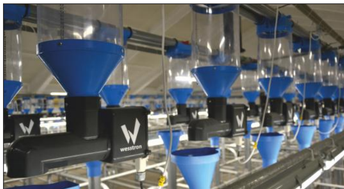
электрические дозаторы корма в секторе для покрытия самок
