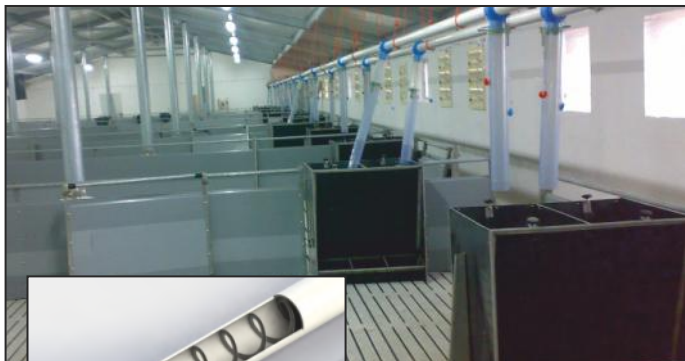
свинарник-откормочник оборудован спиральным транспортёром подачи корма
