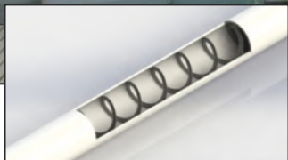
свинарник-откормочник оборудован спиральным транспортёром подачи корма
