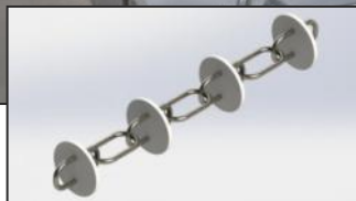
свинарник-маточник оборудован транспортёром цепь-шайба
